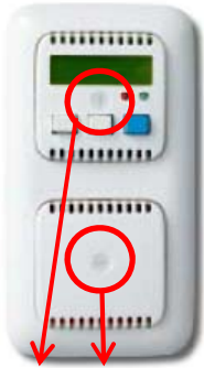
① マイナスドライバー（5mm）でカバーを取外しできます。
