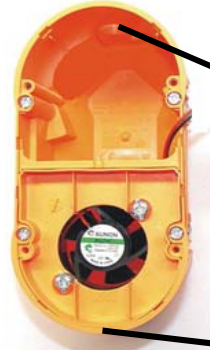
② 3芯ケーブルを通す穴をこの位置にΦ5mm程度
